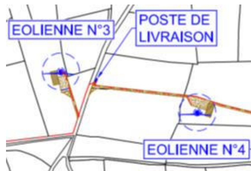
Figure 91 : Localisation du poste de livraison
